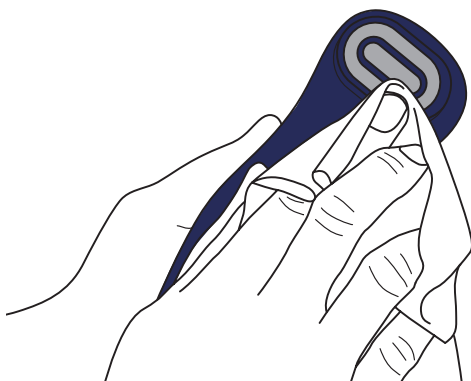
Рисунок 6 – Очистка встроенного электрода
